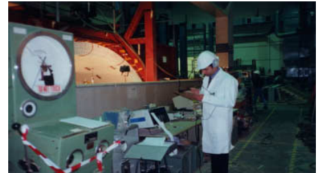
Test conduit par le laboratoire de recherche des transports : une progression de la résistance de 20 tonnes à 41 tonnes.
