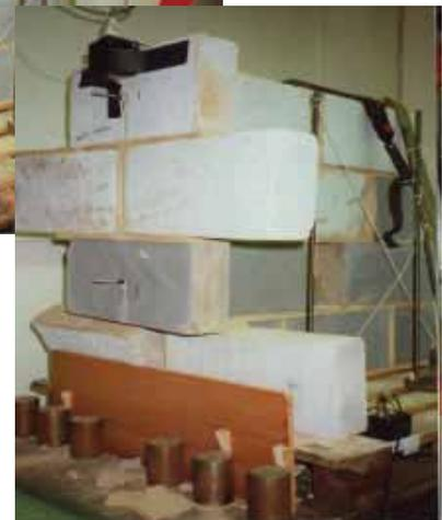
*Test di resistenza alle azioni sismiche condotti all'Università di Southampton in Gran Bretagna hanno mostrato l'efficacia delle ancore Cintec.*
