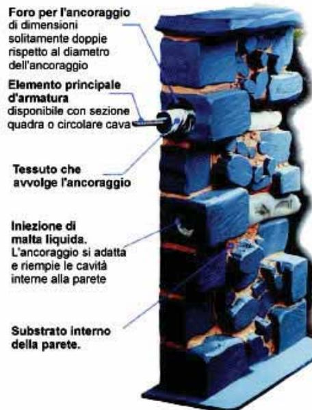
L'installazione di ancore Cintec accresce la ridondanza di un edificio sottoposto ad azioni sismiche: ciò implica che il collasso di un particolare elemento strutturale non comporta il totale collasso dell'edificio.
