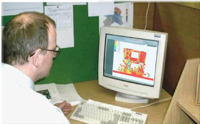
CINTEC 为了提供这样的综合服务，已经开发了先进的计算机模型技术，可以模拟砖石建筑在加强和不加强情况下的状态。
