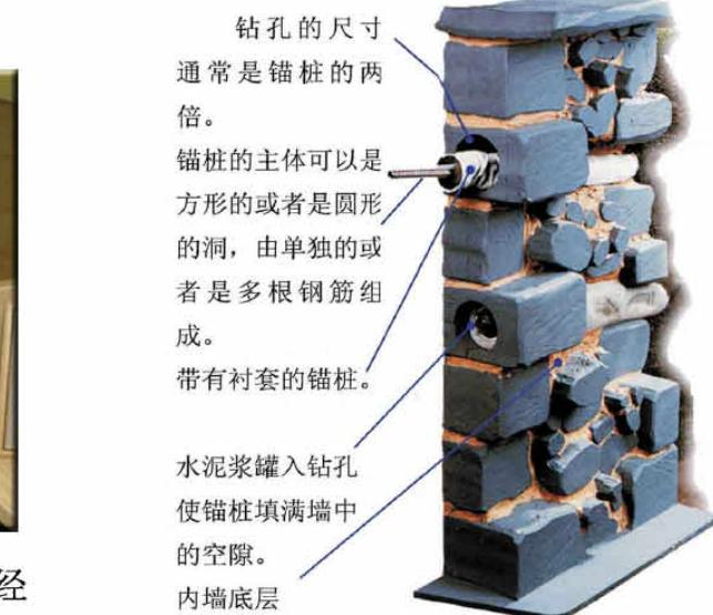
CINTEC 系统包括一个网状纤维衬套和里面的钢筋，中间低压注入一种特别开发的黏性的水泥浆。锚桩自动形成符合墙体内部形状和空档的形体，提供一种强大的机械粘合。锚桩的较大表面区域和带压力的泥浆一起创造出强化系统，可以免去在结构的外部使用难看的模板，从而提供一种隐形的修补。
