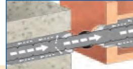
*Se perfora un orificio de diámetro mayor entre los substratos que van a ser anclados.*
