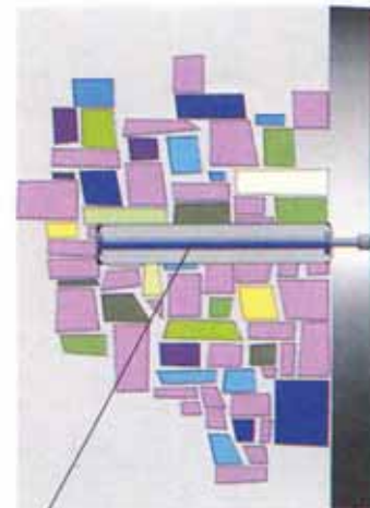
Reparatur einer Natursteinmauer. Der Rundrohr-Nadelanker stabilisiert die Mauer und bietet Anschluß für zusätzliche Aussenbewehrung
